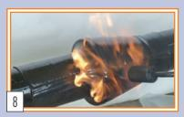
Der Schrumpfvorgang ist beendet, wenn der Schrumpfschlauch überall eng anliegt und ...
