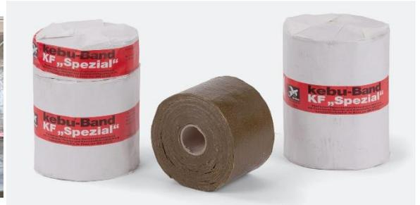
Das **Kebu-Band „KF-Spezial“** ist ein kaltverarbeitbares Korrosionsschutz-Band aus modifizierten Petrolaten, guter Klebkraft, Elastizität sowie erhöhtem Erweichungspunkt. Die kaschierte **PE-Folie** hat eine hohe Diffusionsdichte und verhindert eine Ausspülung der plastischen Masse infolge wechselnden Grundwassers.
